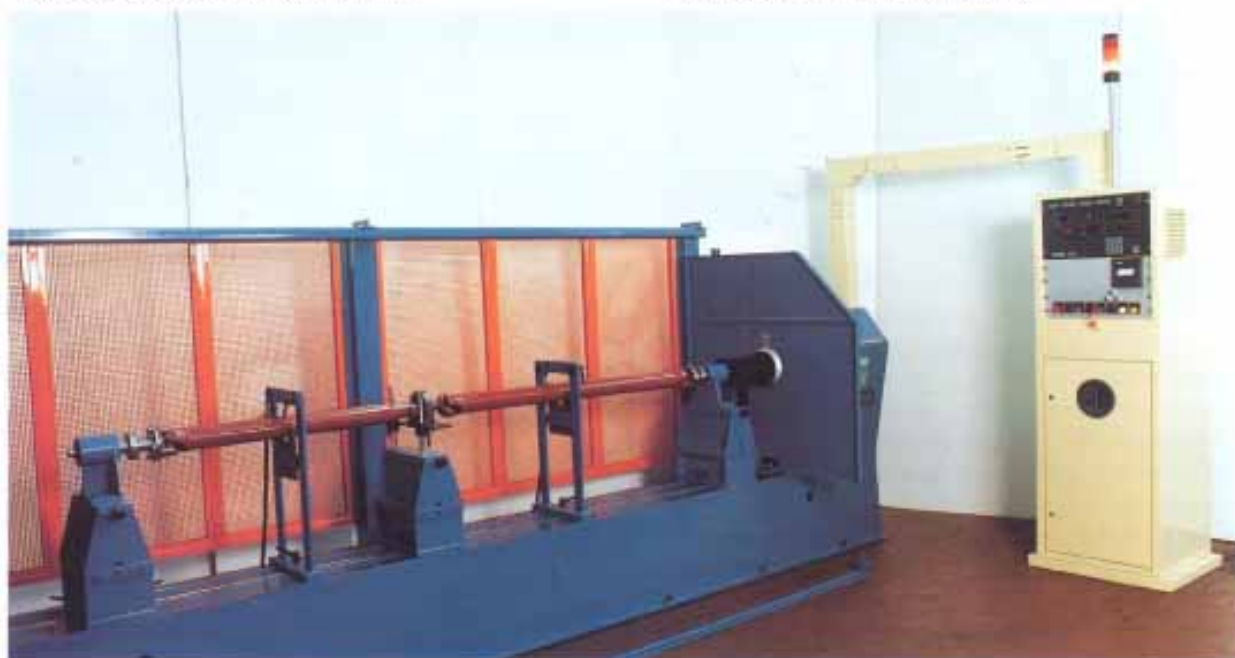
Strumentazione "ZO" in armadio rack per equilibratrice per alberi di trasmissione. La strumentazione gestisce contemporaneamente i tre supporti della equilibratrice.
